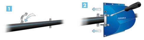
Une fois l'appareil positionné sur la canalisation, branchez votre Gemka® sur le secteur à l'aide de l'alimentation externe fournie. Veuillez vous assurer que votre installation électrique est aux normes (fusible adapté et différentiel de 30mA).
