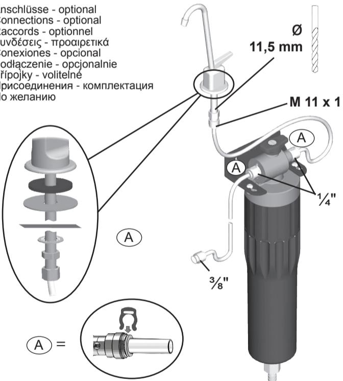
Schlauchanschluss / Hose connection / Raccord de tuyau flexible / Σύνδεση
